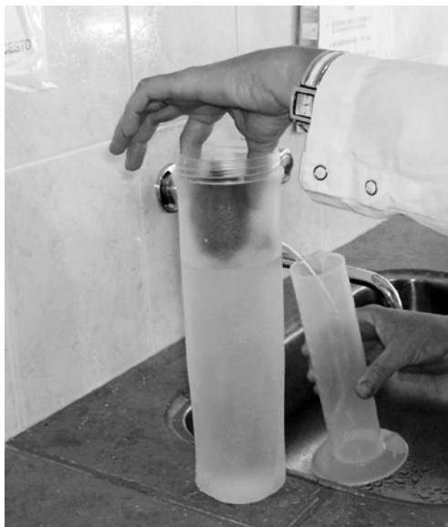
Figura 1. Dispositivo para determinar el volumen del fruto.
