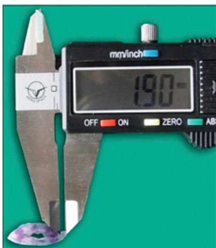
Figura 3: Determinación de la translucidez de la dentina de la zona translúcida utilizando un calibrador a vernier digital.
